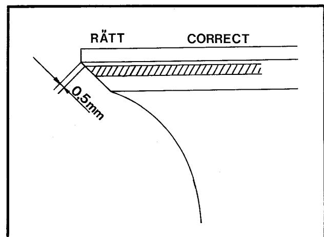
Om anliggningsytan ligger för lågt, fräs om sätet med  $70^\circ$  och  $45^\circ$  fräsen. Se till att bredden på anliggningsytan blir rätt.
