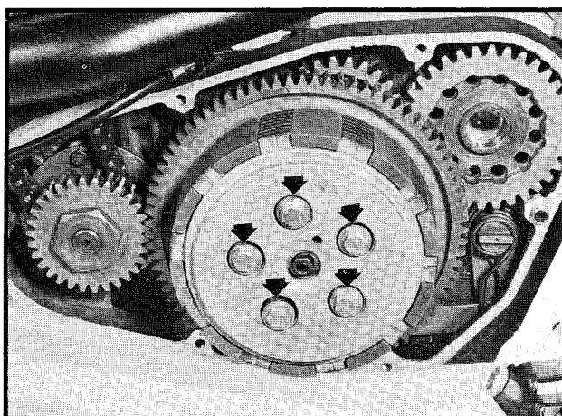
Tag bort tryckstången. Tag bort låsringen för kopplingscentrumet och lossa centrumet. Detta görs bäst genom att skruva 3 skruvar, med lång gänga, genom kopplingscentrumet så att skruvorna trycker på kopplingskorgen och därigenom trycker upp kopplingscentrumet.
