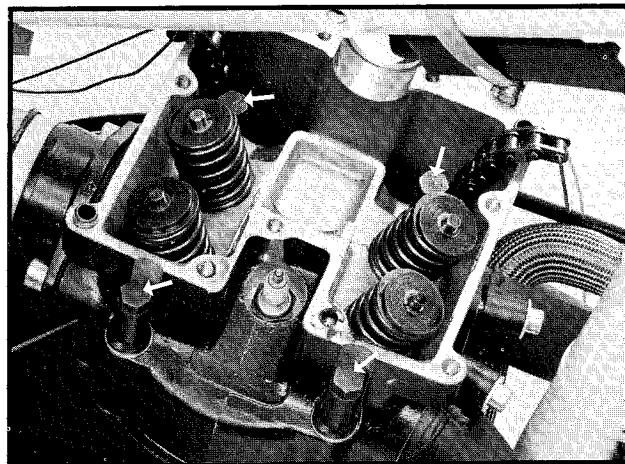
Se till att kolven är i ÖD på kompressionstakten.
