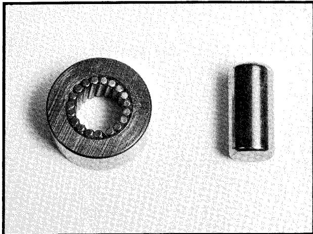
Tag ur axeln ur den nya rullyftaren, se till att nålarna ligger kvar längs kanten.
