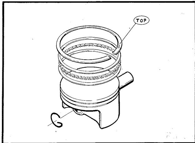
Tag bort kolvringarna från kolven och kontrollera kolvringgapet. Om det är mer än 0,60 mm skall kolvringen bytas.
