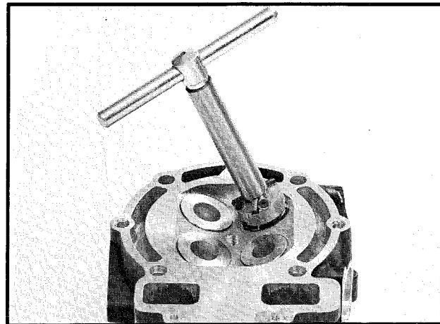
Använd  $15^\circ$  fräsen och  $70^\circ$  fräsen för att få rätt bredd på anliggningsytan ( $45^\circ$ ).
