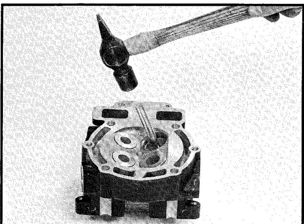
Värmtopplocket till 200° C i ugn (380° F)
