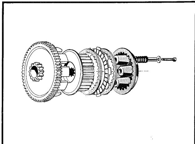
OBS! Det skall vara 8 lameller med belägg och 9 lameller utan belägg.
