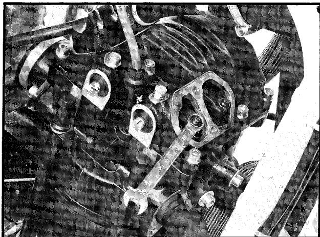
Använd en liten skravmejsel och skruva justerskruven så att inget spel kan känna mellan vipparmen och ventilen.
