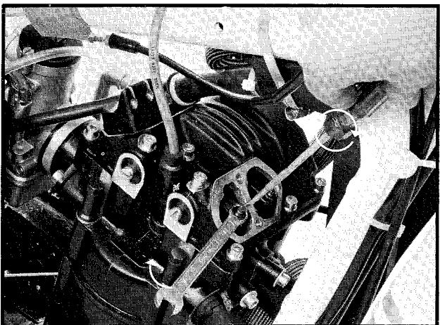
Vrid skruven tillbaka 2/16 varv (insug) eller 3/16 varv avgas. Ventilspel 0.10 mm insug och 0.15 mm avgas.
