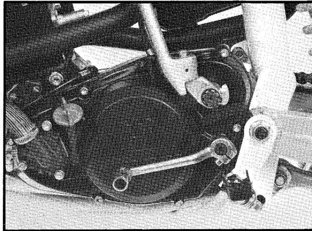
Lossa de 5 skruvorna som håller kopplingsfjädrarna. Tag bort tryckplattan, kopplingsfjädrar, distanshylsorna och alla lameller.
